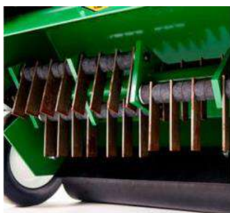
Rotore a 30 lame mobili in acciaio temperato
