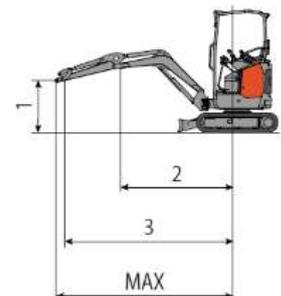
La capacità di sollevamento è basata sulla norma ISO 10567 e non eccede oltre il 75% del carico statico di ribaltamento o dell'87% della capacità di sollevamento idraulico della macchina.
